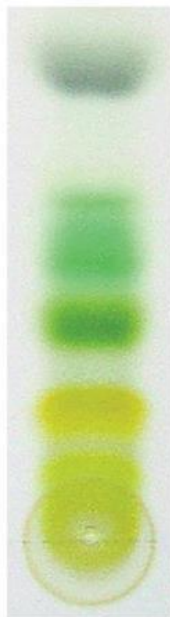
Cromatografia de diferents compostos de una fulla com la clorofil·la o la luteïna.
